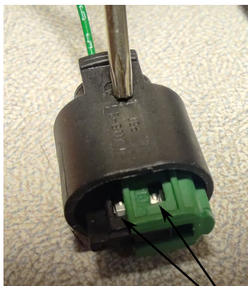
2.Kontaktsicherung wie angegeben verschieben und verrasten (1 Rastnoppen) Slide and lock the second contact retainer as shown (1 locking knob)
